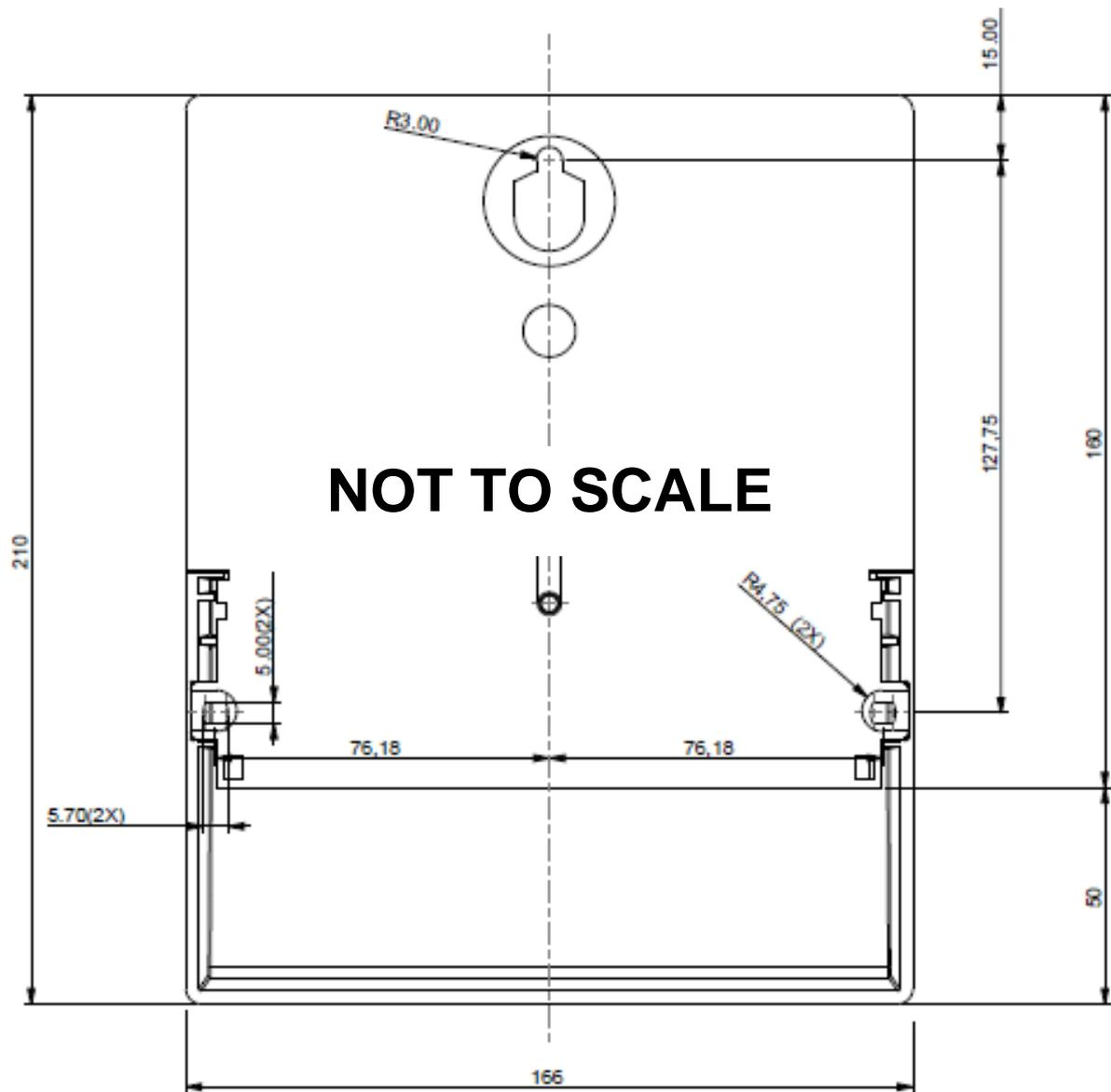
**Figure 6.1-2: EET Meter Dimensions**
