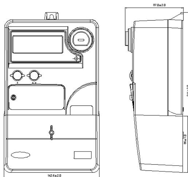
**Figure 4.2-3 Meter Dimensions**
