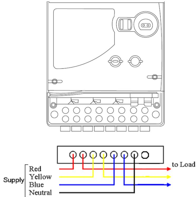
Wiring Configuration for Sprint 3 Phase 4 Wire 240V Meter
