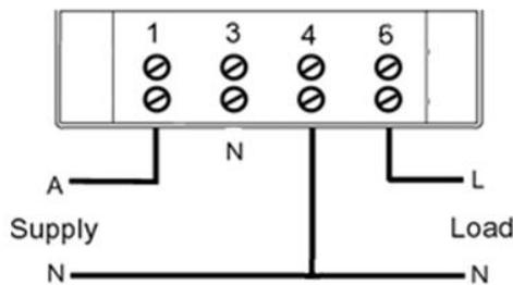
**Figure 2.2-4: HLA Meter Terminals**
