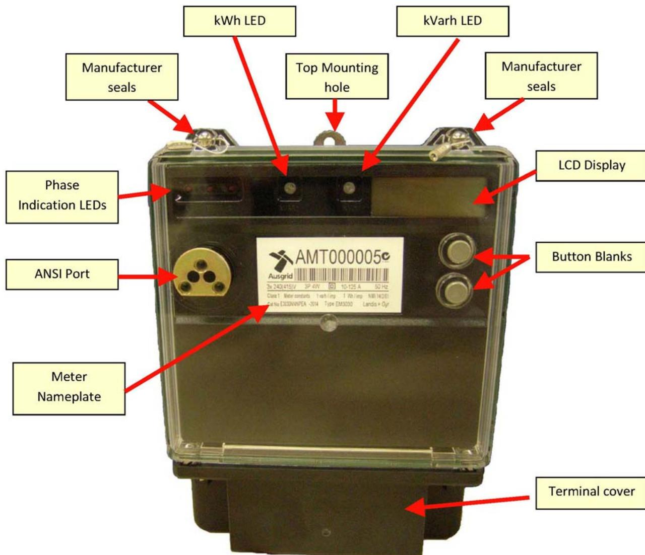
Figure 3.1-3 AMT Meter layout
