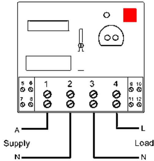
**Figure 4.1-4 E1000 meter wiring schematic**
