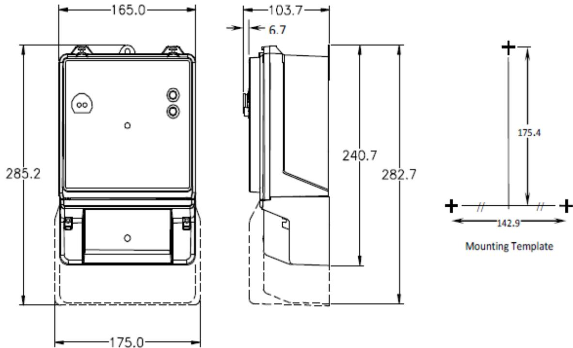
**Figure 3.1-2 AMT Meter dimensions**
