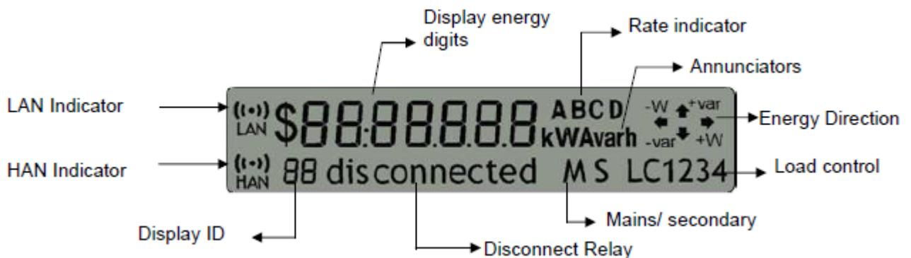
**Figure 5.4-6: LGC meter display**
