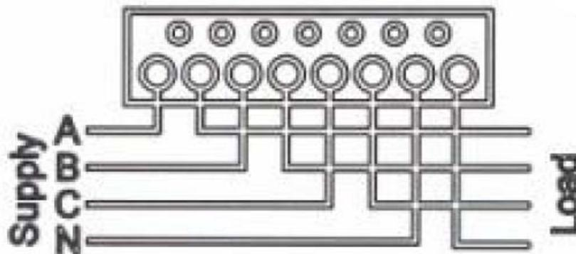
**Figure 6.3-4 Meter wiring**
